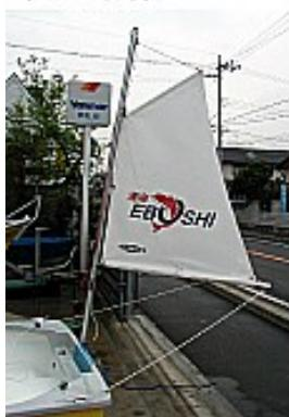
スパンカーはボートを風に立てる(船首を風上に向ける)ための装備です。これにより風に抵抗して同じ位置に止またり、潮の流れに乗って走りが可能になります。スパンカーは帆と帆が張られないとき効果が得られないで各部のロープを調節してたるまないように張って下さい。
